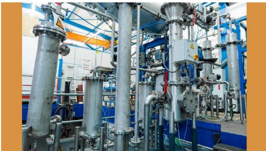
En novembre 2021, la construction de l'usine pilote allemande a été finalisée avec l'installation du système de production de phosphate mono-ammoniacal (MAP), qui a été couplé à l'usine de Pyrolyse (TCR, en anglais Thermo-Catalytic Reforming ↔ Transformation Thermo-Catalytique).
