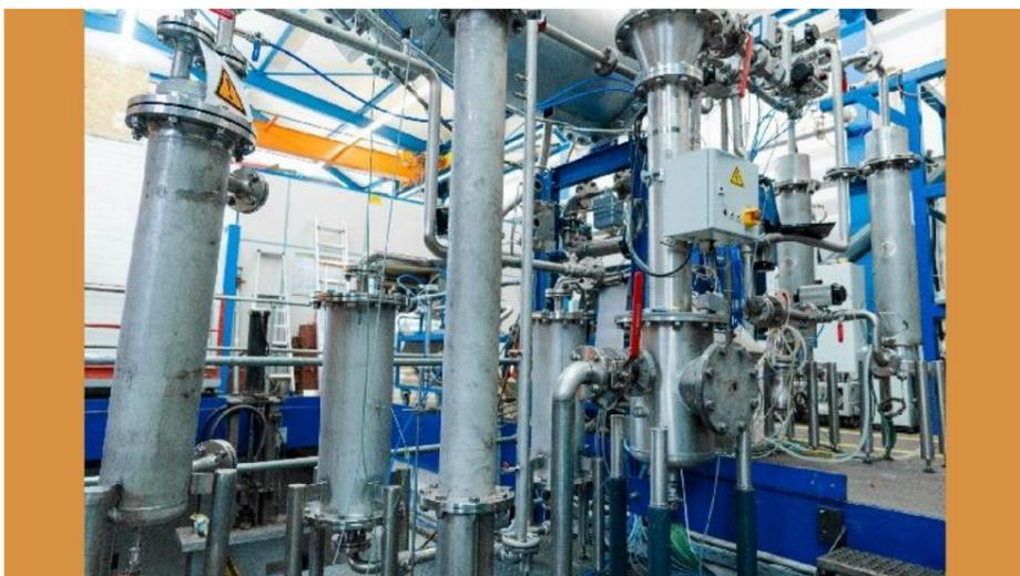
Im November 2021 wurde der Bau der deutschen Pilotanlage mit der Installation des Mono-Ammonium-Phosphat-Systems (MAP) abgeschlossen, das mit der thermo-katalytischen Reformierungsanlage (TCR) gekoppelt wurde.
