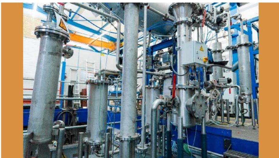
A novembre 2021 si è conclusa la costruzione dell'impianto pilota tedesco con l'installazione del sistema Mono-Ammonium Phosphate (MAP), che è stato accoppiato all'impianto di Thermo-Catalytic Reforming (TCR).
